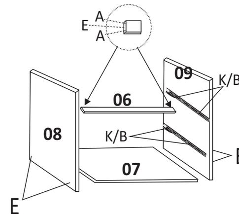
**Passo 04 /** Depois da caixa da gaveta montada unir com paraf. (C) na lateral e no tampo com paraf. e trapézio (J+C).
